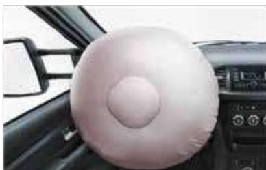
**Airbag del conductor**
